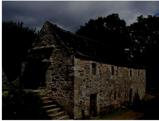
Maisons du village de Kerouat : toitures à coyaux et à pureaux décroissant
